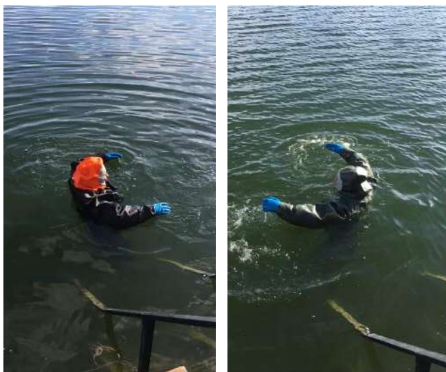
Рисунок 3 – Определение положительной плавучести и остойчивости ККИЗ
