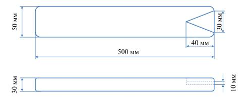
Рисунок 3 – Разработанное устройство – пожарный челнок
