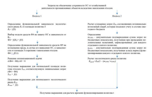
Рисунок 2. — Методика решения задачи по управлению безопасностью функционирования промышленного объекта вследствие образования и накопления отходов
