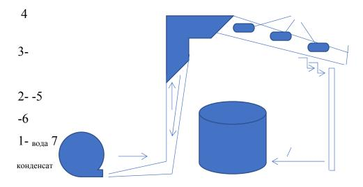
1 – холодильный агрегат с насосом, 2 – трубопроводы холодной воды, 3 – пористый навес, 4 – тонкостенные конденсаторы, 5, 7 – трубопровод для конденсированного нефтепродукта, 6 – емкость нефтепродукта.
