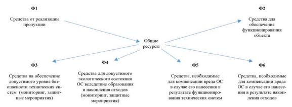
$\Phi 1 > \Phi 2 + \Phi 3 + \Phi 4 + \Phi 5 + \Phi 6$  – условие функционирования промышленного объекта
