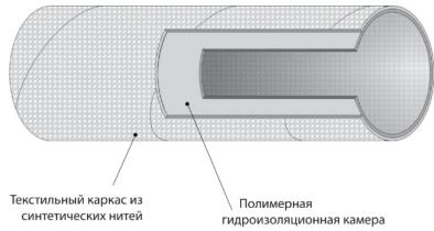
Рисунок 1 – Состав напорного пожарного рукава
