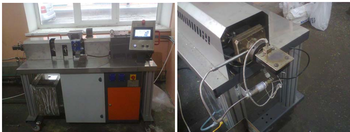
Рисунок 1 – Двухшнековый экструдер «Suplast 25/2» с формующей оснасткой
