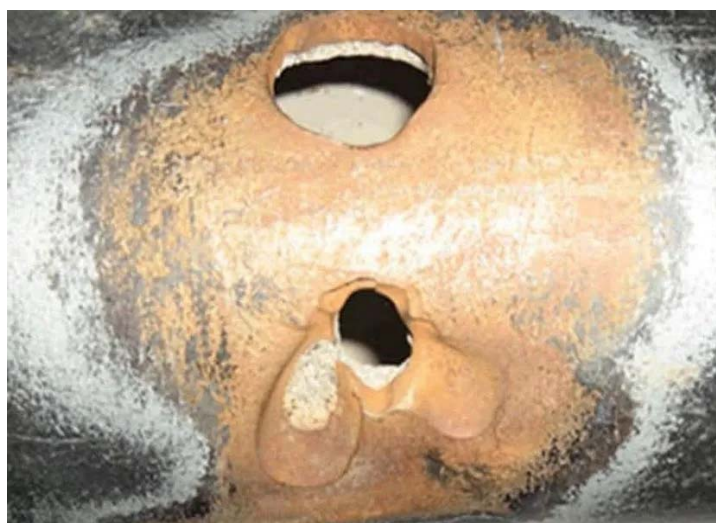
Рис.1 – Воздействие блуждающих токов на трубопровод
