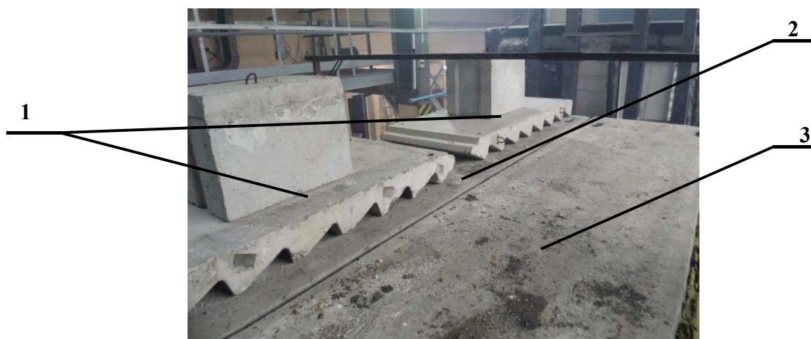
1 – равномерно приложенная нагрузка; 2 – железобетонная плита, испытываемая под нагрузкой; 3 – железобетонная плита, испытываемая под собственным весом без нагрузки
