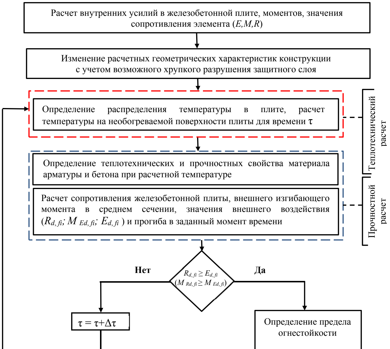
Рисунок 18. – Методика расчета предела огнестойкости железобетонных предварительно напряженных плит без сцепления арматуры с бетоном
