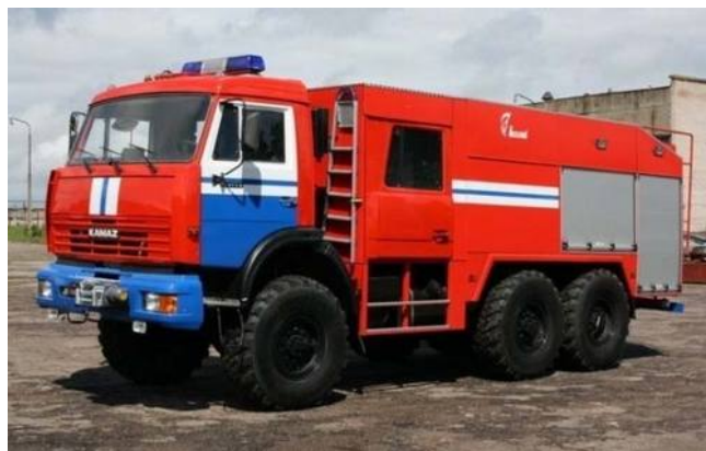
Рисунок 3. – Пожарная АЦ-7,0-40 (43118) с отсеками расположенными у кормы
