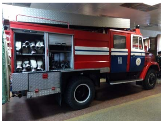
Рисунок 7. – Пожарная АЦ-2,5-40 (433362) с цистерной квадратной формы
