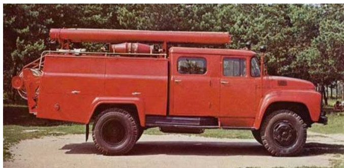
Рисунок 5. – Пожарная АЦ-40 (130) - 126 с цистерной круглой формы
