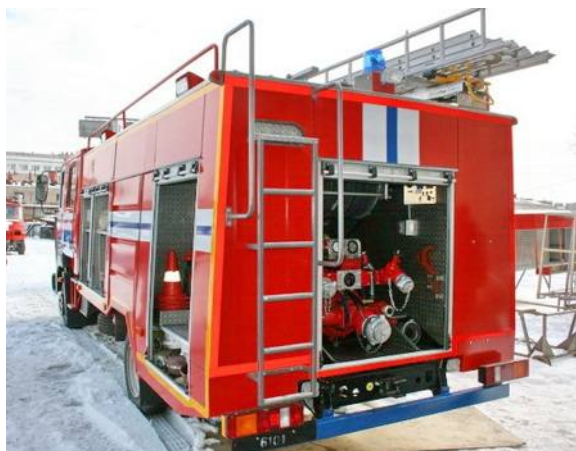
Рисунок 2. – Пожарная АЦ-2,0-33/4 (437041) с задним расположением ПН в отдельном отсеке
