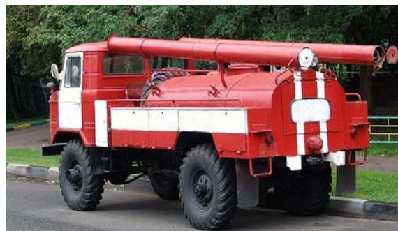
Рисунок 6. – Пожарная АЦ-40 (66) - 146 с цистерной эллиптической формы
