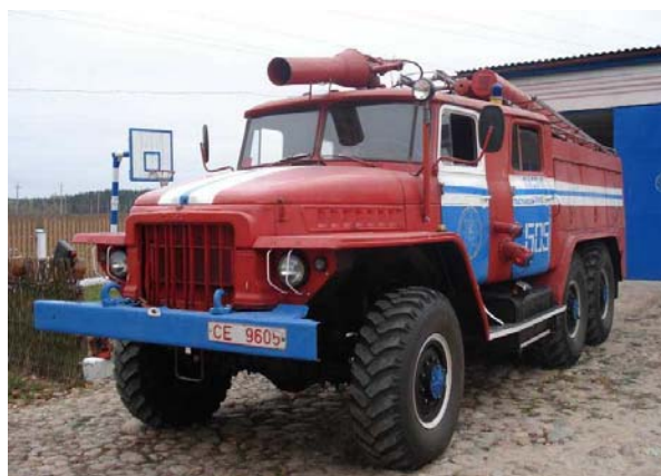
Рисунок 8. – Пожарная АЦ-40 (375) Ц1 с цистерной квадратной формы, с нижней стороной изогнутой по дуге окружности
