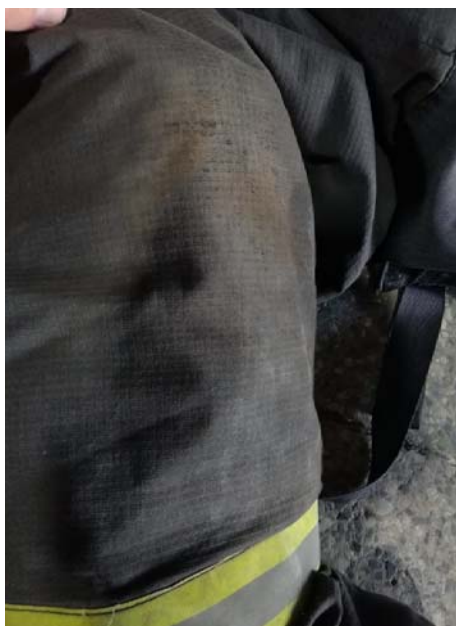
Рисунок 3 – Повреждение одежды в результате воздействия на нее искр отрезного круга
