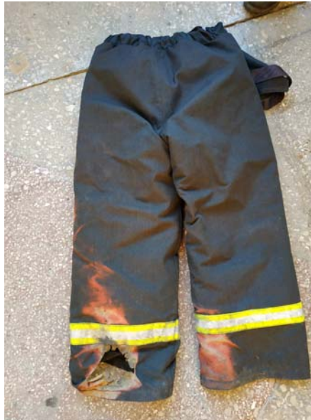
Рисунок 2 – Повреждение одежды в результате воздействия на нее высокой температуры и открытого пламени
