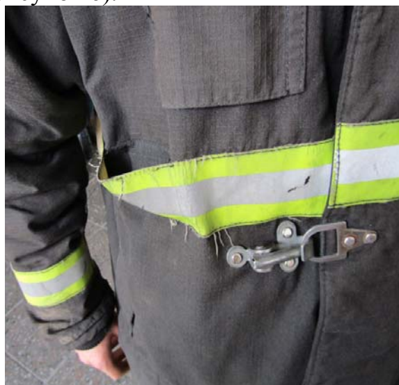
Рисунок 6 – Разрыв нитей, крепящих световозвращающую ленту, в результате механических воздействий
