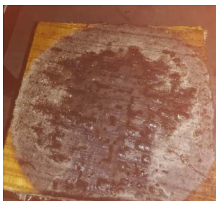
Рисунок 2 – Образец древесины осины после проведенных испытаний
