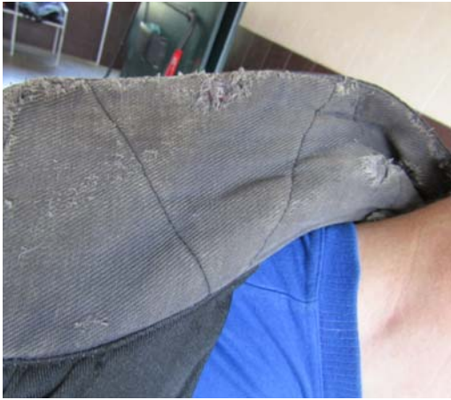
Рисунок 7 – Повреждение в области воротника в результате механических воздействий
