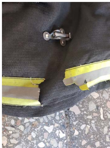
Рисунок 4 – Повреждение нитей и световозвращающей ленты в результате воздействия на нее высокой температуры
