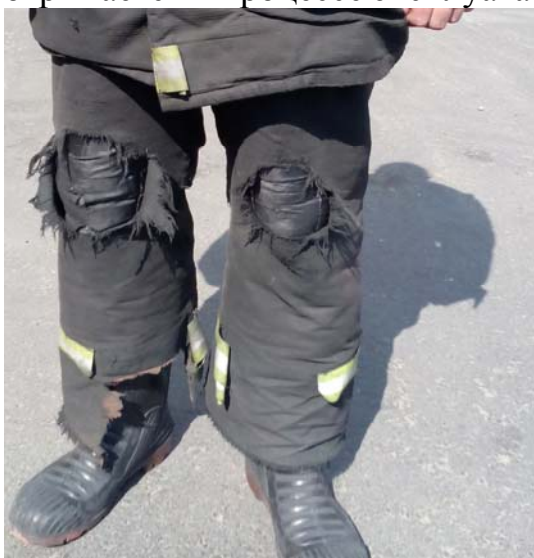
Рисунок 5 – Повреждение в области коленного сустава в результате механических воздействий
