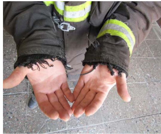
Рисунок 8 – Повреждение в области рукавных манжет в результате механических воздействий
