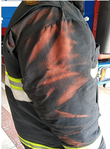
Рисунок 2 – Повреждение одежды в результате воздействия на нее высокой температуры и открытого пламени
