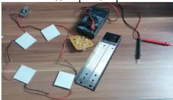
Рисунок 2 - Преобразователь тепловой энергии в электрическую с элементами Пельтье
