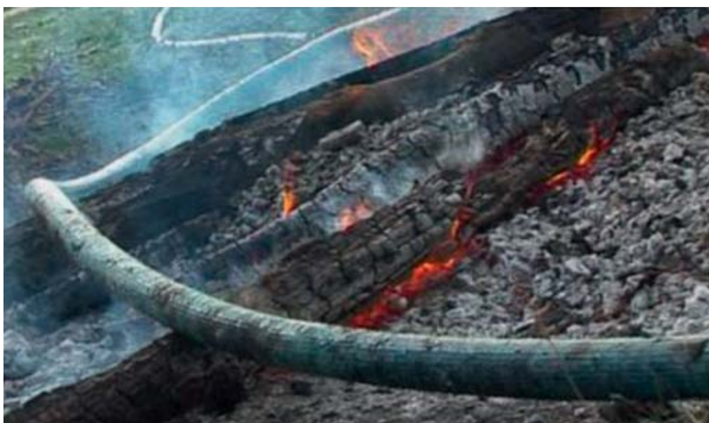
Рисунок 1 - Перколированные термостойкие напорные пожарные рукава
