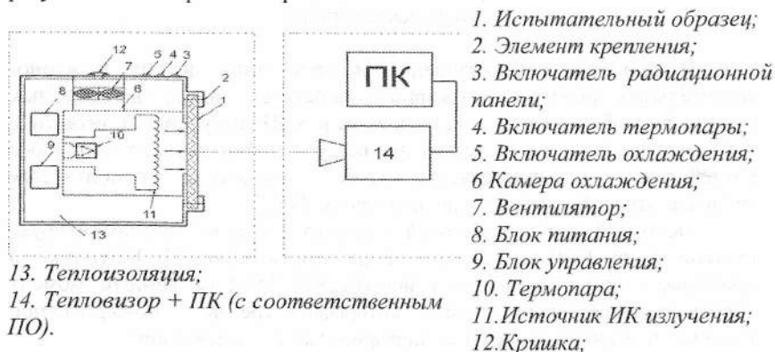
Рис. 1 Структура прибора для определения тепловых характеристик пакета материалов БОП
