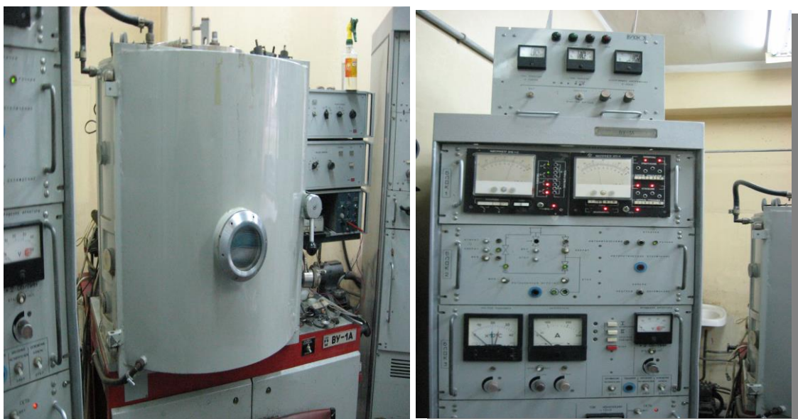
Рисунок 1 – Вакуумная камера и узел управления
