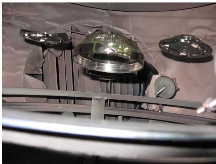
Рисунок 2 – Нанесенное экранирующее покрытие на дымовой пожарный извещатель
