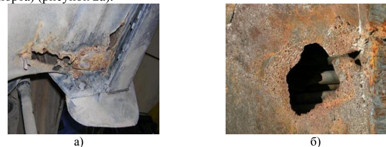
Рисунок 2 – Наружные (а) и внутренние (б) поверхности цистерны, подвергшейся коррозии
