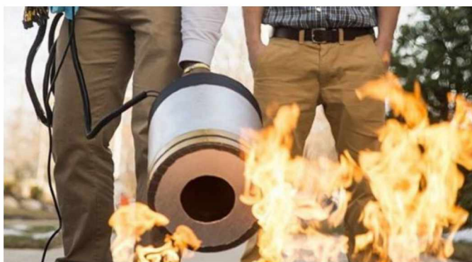
Рис. 2 Вид коллиматора звукового огнетушителя
