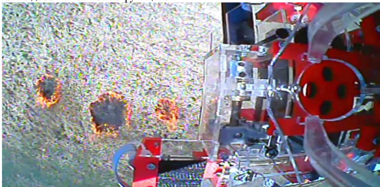
Рисунок 2 – Сброс и поджог шаров с этиленгликолем.
