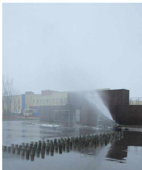
Рисунок 4.5 – Определение эффективной дальности распыленной струи ствола СПРУК 50/0,7 «Викинг»
