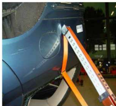
Рисунок 2 – Общий вид макетов для формирования навыков по стабилизации автомобилей
