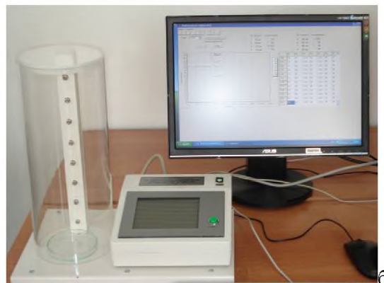
Рисунок 1 – Установка для определения концентрации паров ЛВЖ при опорожнении и наполнении резервуаров: а – схема установки, б – внешний вид установки
