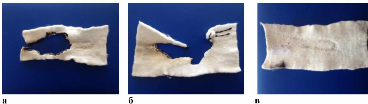
Рисунок 1 – Фотографии полиэфирного утеплителя после огневых испытаний; а – без стадии активации \text{SnCl}_2 , б – без стадии термофиксации, в – оптимальная схема обработки
