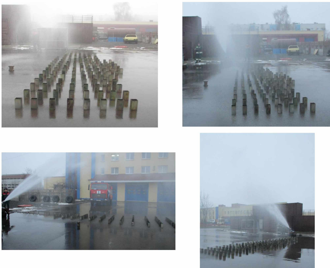
Рисунок 1 – Определение эффективной дальности распыленной струи ствола СПРУК 50/0,7 «Викинг»
