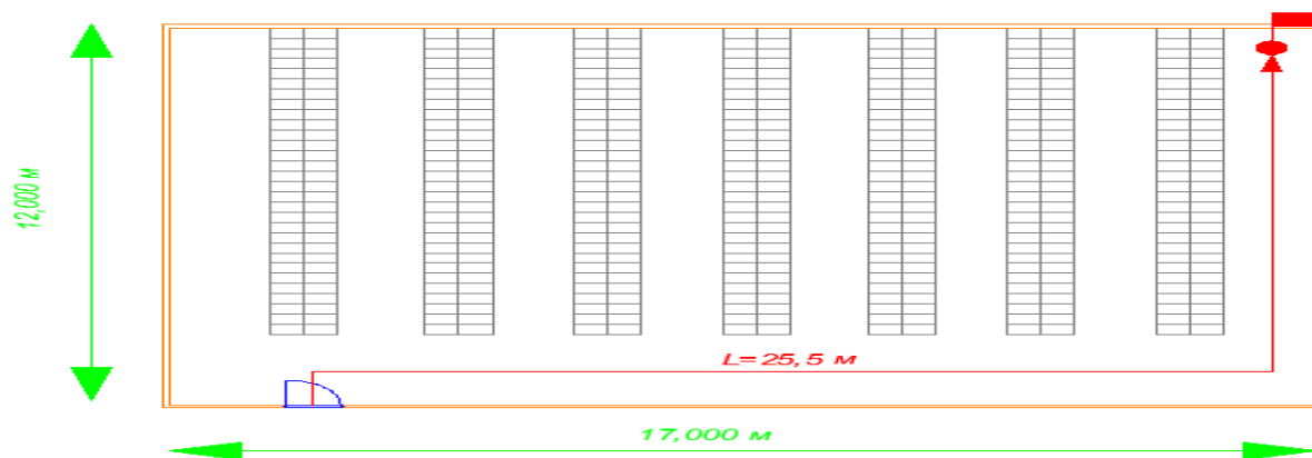
Рис. 2 Схема складского помещения
